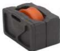
Roldana sem Regulagem com Rolamento ROL 427R (40Kg PAR)
